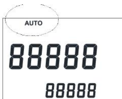
Obr.: Režim automatické volby rozsahů je indikován na displeji symbolem AUTO
