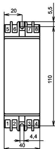
Geometrie vrtání montážních otvorů
