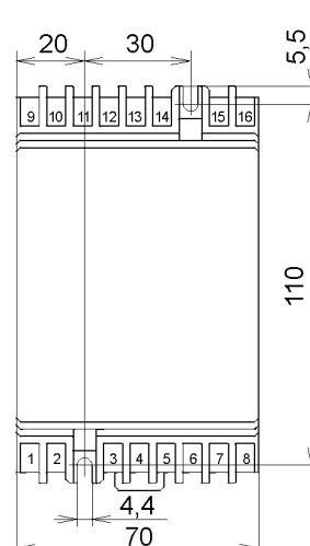
Geometrie vrtání montážních otvorů
