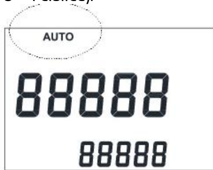
Obr.: Režim automatické volby rozsahů je indikován na displeji symbolem AUTO
