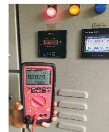
DMM 6016 měření VAC.
