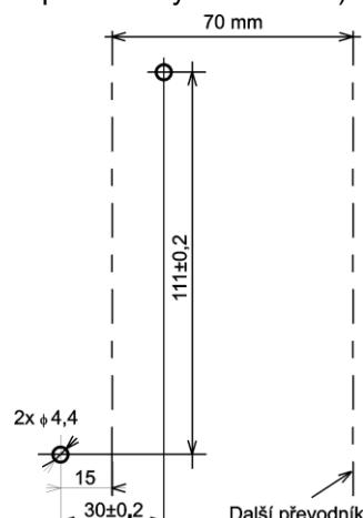
Konstrukční rozměry – provedení 2 - úzké pouzdro
