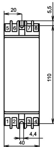
Geometrie vrtání montážních otvorů
