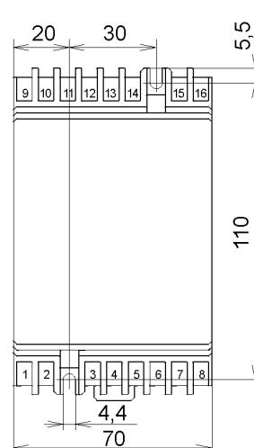
Geometrie vrtání montážních otvorů
