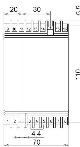
Geometrie vrtání montážních otvorů
