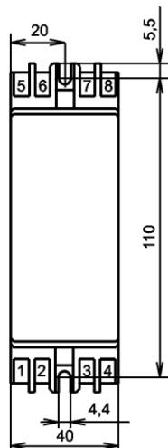
Geometrie vrtání montážních otvorů
