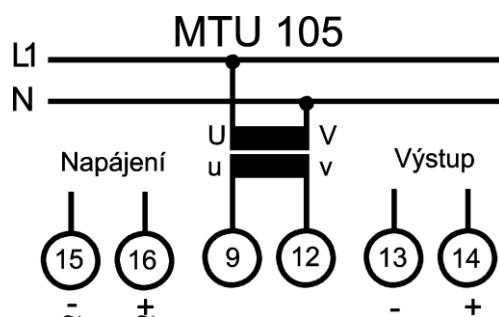
**Legenda:** na svorky převodníku č.9, 12 se připojí výstup měřicího transformátoru napětí, nebo přímo měřené napětí (dáno rozsahem převodníku a velikostí snímaného napětí); na svorky převodníku č.13, 14 (výstup převodníku) se připojí vyhodnocovací zařízení; na svorky 15, 16 (pomocné napájení) se připojí napájecí napětí dle štítkového údaje převodníku (dle volby zákazníka při zadávání objednávky)
